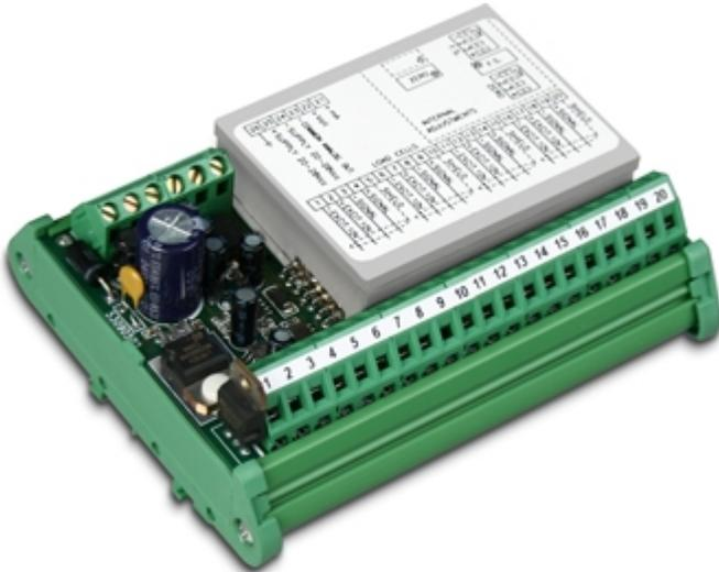
Trasmettitore di peso con uscita analogica a scelta 0-20mA, 4-20mA, 0-10Vdc oppure +/- 5Vdc. Adatto per montaggio retro quadro oppure in cassetta stagna su barra omega. Normalmente utilizzato con schede analogico/digitali a 12 bit installate su PLC
